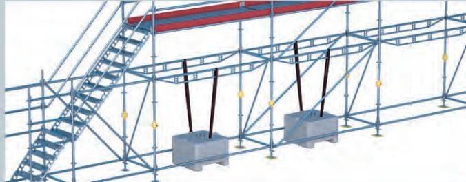
**Praktisch** – durch zahlreiche Anschluss- und Anbaumöglichkeiten können Blocker jeder Gerüstsituation angepasst werden – stapeloptimiert. Blocker haben ein Gewicht von
