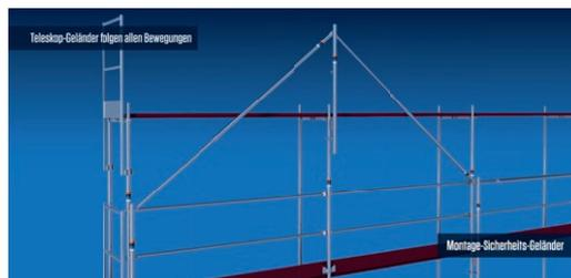
Das Teleskopgeländer ermöglicht Umbau ohne Geländerdemontage
