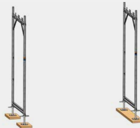
Bild 6: Aufbau des ersten Gerüstfeldes: Vertikalrahmen
