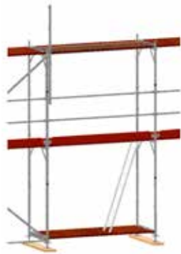
Bild 26: Montage des ersten MSG-Pfostens.
