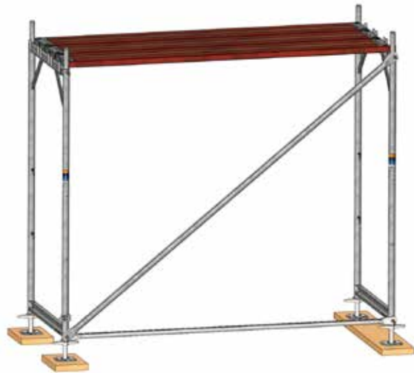
Bild 16: Fertig montiertes erstes Gerüstfeld
