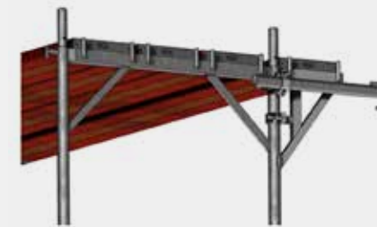
Bild 37: Kurzer Gerüsthalter, Ausführung mit Verbreiterungskonsolen innen
