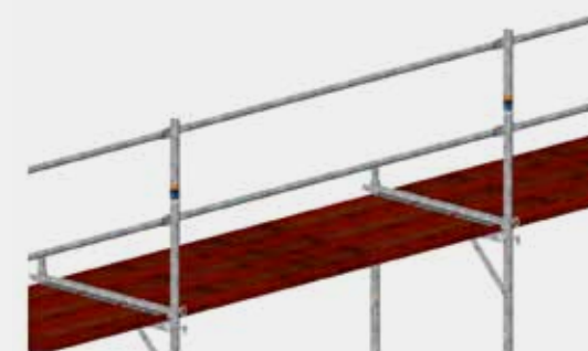
Bild 45: Oberer Abschluss mit Geländerpfosten und Belagsicherungen.
