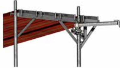
Bild 39: V-Halter, Konfiguration mit Innenkonsolen
