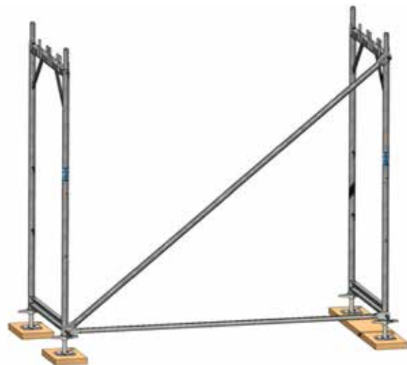
Bild 13: Aufbau des ersten Gerüstfeldes: Vertikaldiagonale
