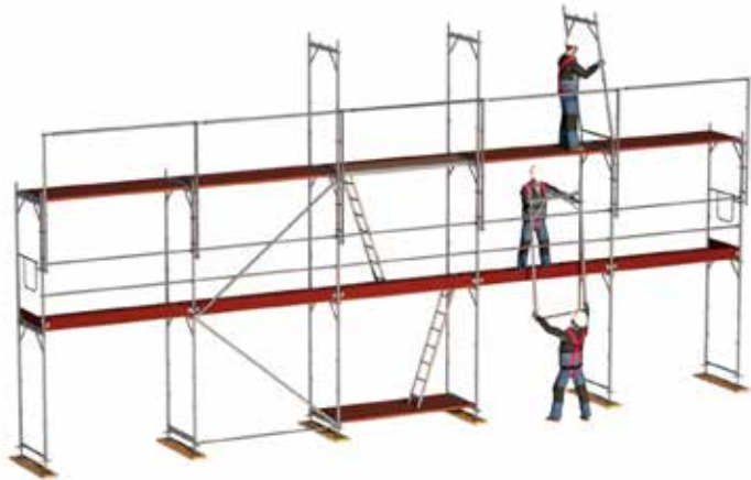
Bild 30: Montage der Gerüstlage im Schutze des MSG.
