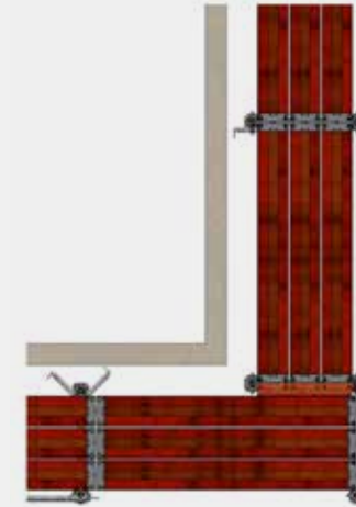
Bild 41: Verankerungen im Eckbereich, Ausführung mit zwei Vertikalrahmen
