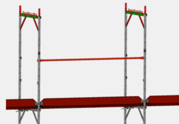
Bild 23: Empfohlene Anschlagpunkte am Vertikalrahmen
