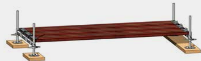
Bild 4: Systembeläge auf Belagtraversen
