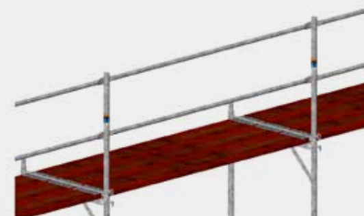
Bild 44: Oberer Abschluss mit Geländerpfosten mit Traversen.
