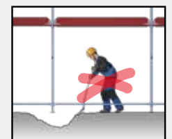
Standstabilität des Gerüsts nicht durch Ausschachtungen gefährden
