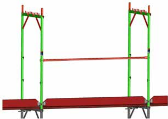
Bild 21: Zulässige Anschlagpunkte für die PSaGA am Vertikalrahmen.
