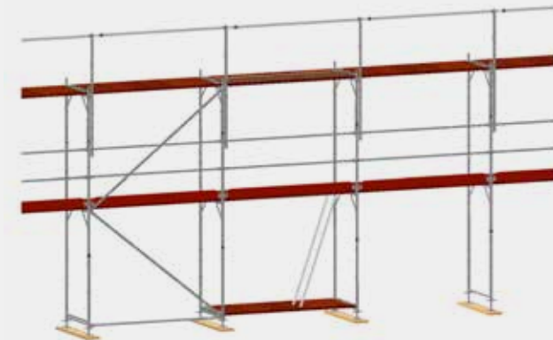
Bild 29: Montage der weiteren MSG-Einheiten
