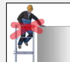
Auf Gerüstbeläge nicht abspringen
