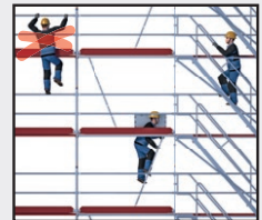
Zum Auf- und Abstieg nur vorhandene Leitern oder Treppen benutzen
