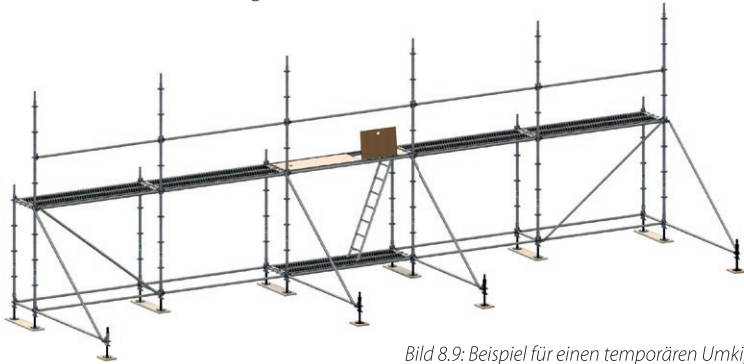
Bild 8.9: Beispiel für einen temporären Umkippschutz
